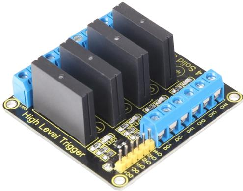
Dieses 4-Kanal Halbleiterrelais ist zum Schalten von Wechselspannung geeignet. Es hat eine galvanische Trennung durch integrierte Optokoppler und das Schalten der Last erfolgt mit Transistoren, weshalb es eine viel höhere Lebensdauer als mechanische Relais hat.
